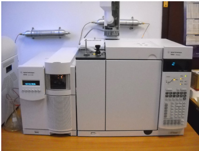
Slika 2. Vezani sustav plinska kromatografija-masena spektrometrija (GC-MS) (Foto: T. Svalina, 2022). Figure 2. Gas-chromatography-mass spectrometry system (GC-MS) (Photo: T. Svalina, 2022).
